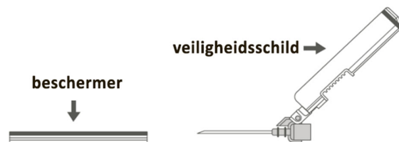
Afbeelding C: onderdelen van de veiligheidsnaald (gebruiksklaar)
